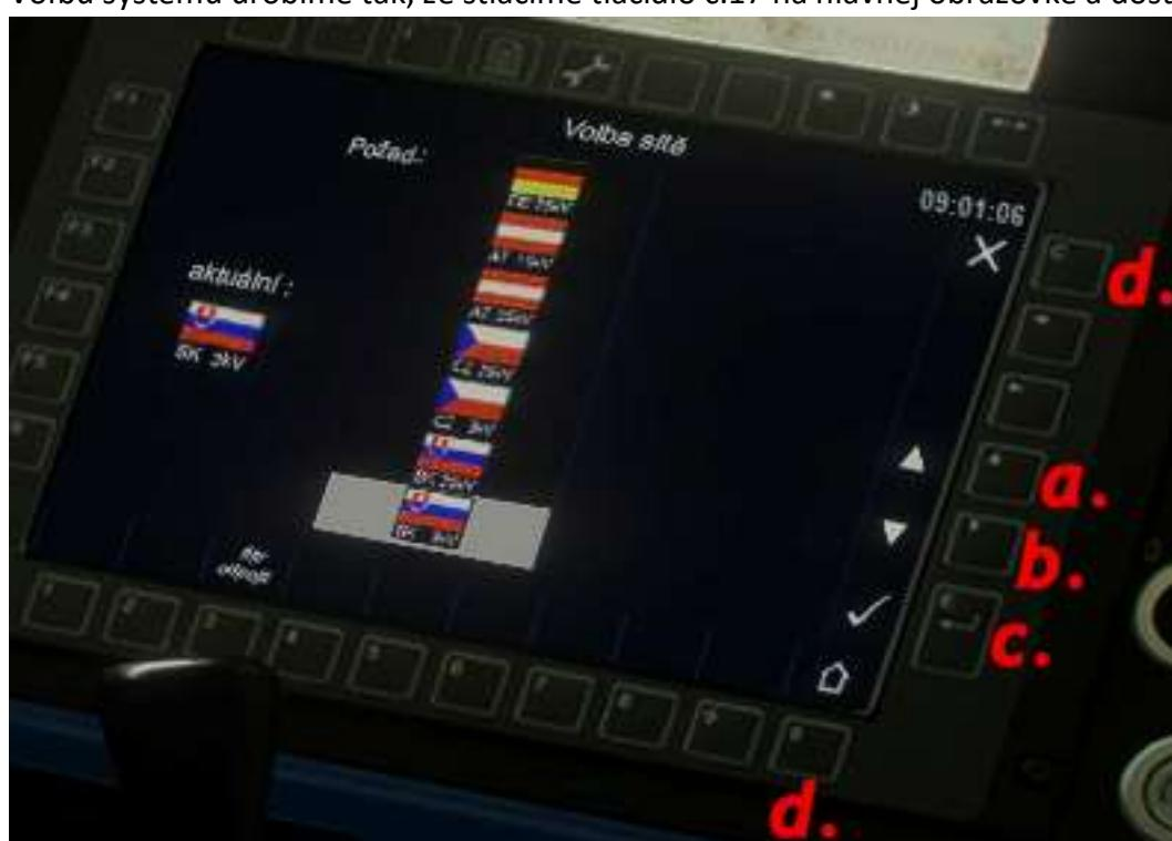
Šípkami **a.)** a **b.)** si vyberieme požadovaný systém. V tomto prípade SK 3kV.
